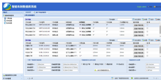
图 10 加工特征、刀具、切削参数选择推荐界面
