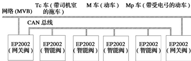
图 3 EP2002 制动系统结构
