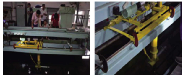
图 6 水轮机拖曳水池实验
