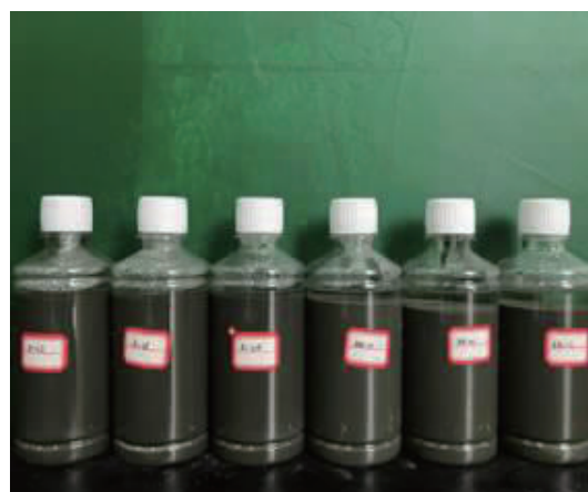
图6 充填料浆泌水及沉缩率测试
