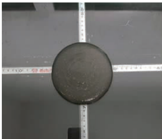
图5 充填料浆流动度测试
