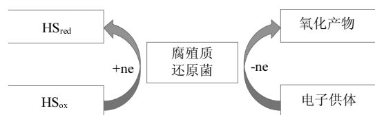
图 4 腐殖质还原菌还原腐殖质示意
