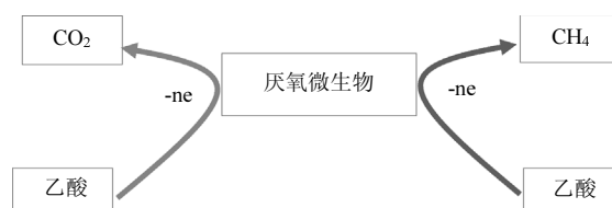
图 6 微生物耦合还原腐殖质和产甲烷示意
