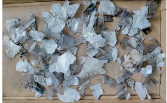
图 3  $+19-37\text{ mm}$  物料分选后的非金属物
