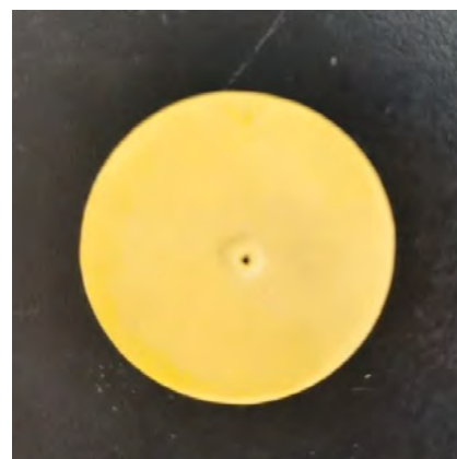
图 9 \text{BiVO}_4 颜料在 PMMA 中的应用效果图
