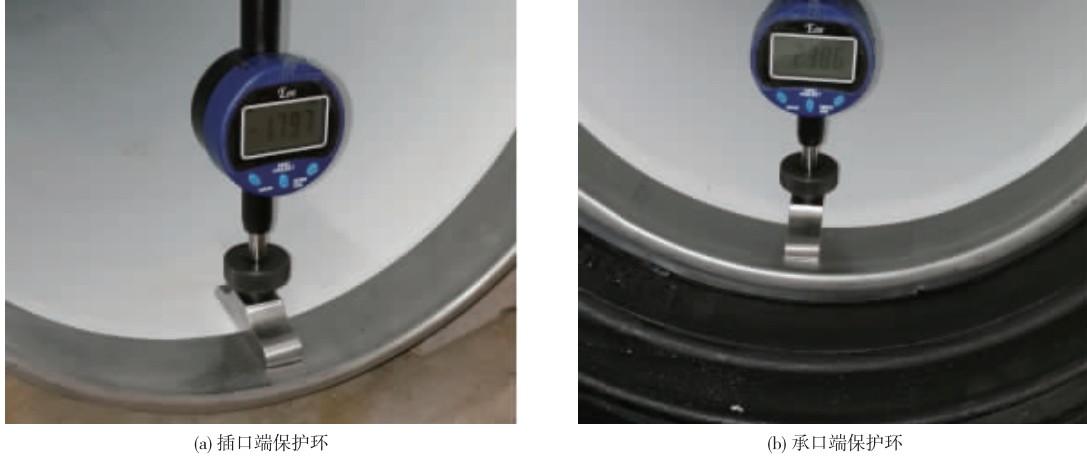
图 5 球墨铸铁聚乙烯复合管端部保护环
