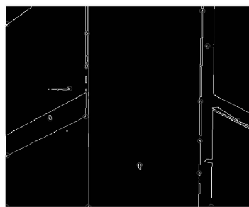
图 6 角点检测算子提取索塔的检测图像
