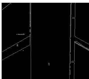
图 5 Canny 算子提取索塔的边缘图像
