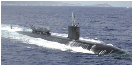
图 10 搭载于潜艇平台上的 ASDS Fig. 10 ASDS mounted on the submarine platform
