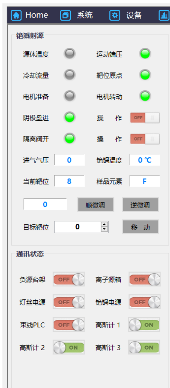
图 7 换靶控制界面图
