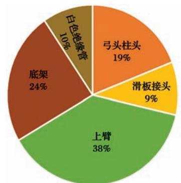
(a) 部件裂纹故障率统计
