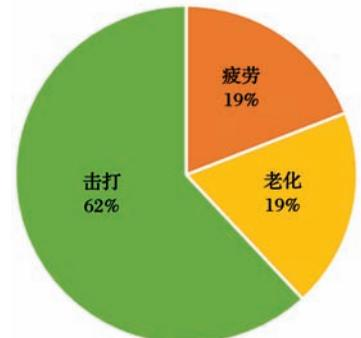
(b) 断裂类型故障率统计
