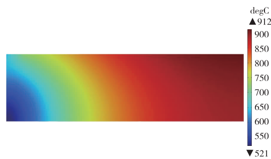
图 14 22 cm 铝水平电解槽阴极炭块温度分布
