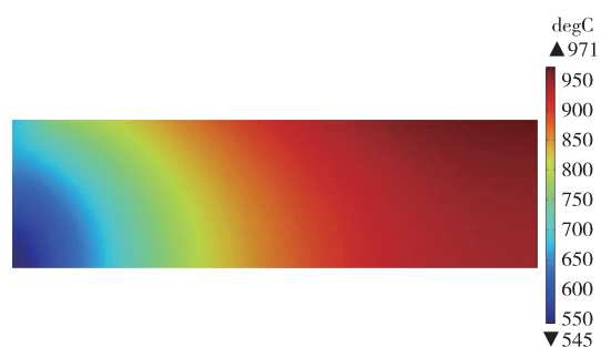
图 13 20 cm 铝水平电解槽阴极炭块温度分布
