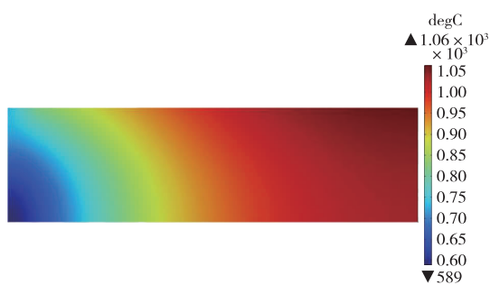
图 12 18 cm 铝水平电解槽阴极炭块温度分布
