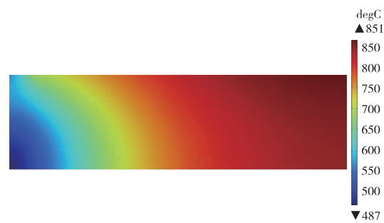
图 15 24 cm 铝水平电解槽阴极炭块温度分布
