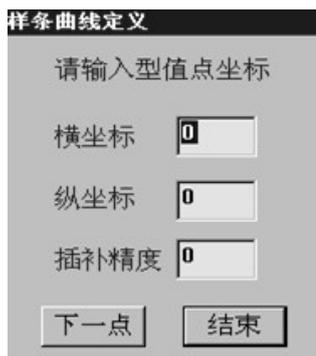
图 6 系统样条曲线的输入
