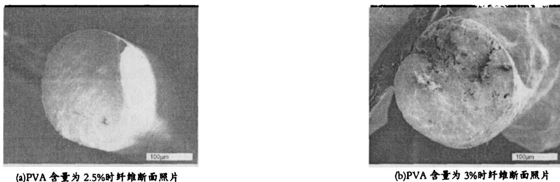
图4 PVA含量不同时纤维断面照片
