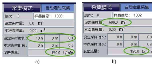
图9 采集模式设定页面. a)定时采集模式; b)定量采集模式
