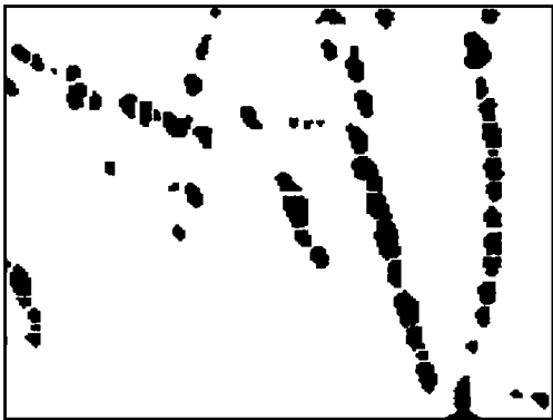
图 4 自动断开后的蚀坑
