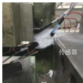
(b) 方形试样安装示意图
