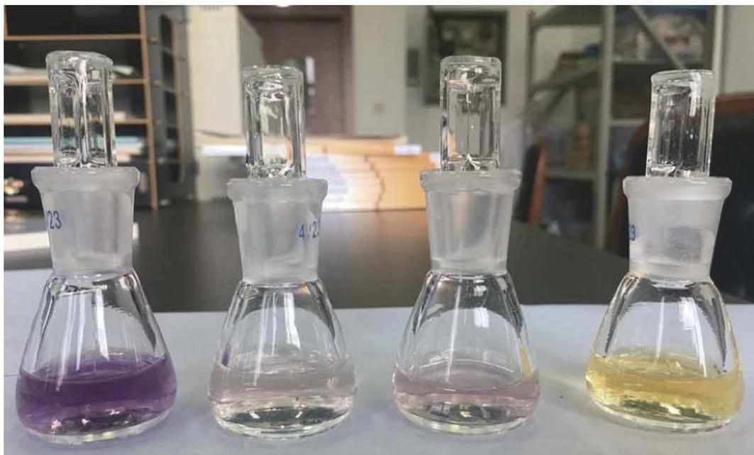
(a) 原料水杨酸用乙醇溶解后，加入 1%  $\text{FeCl}_3$  溶液
