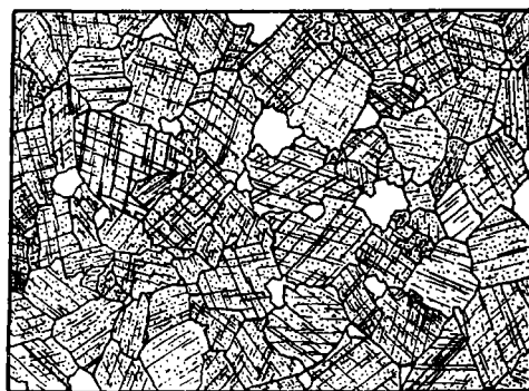
图1 中晶白云岩中的晶间孔 (据昆明西山剖面R 10 照片描绘,面孔率=5%)
