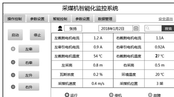
图 5 采煤机智能化监控系统主界面
