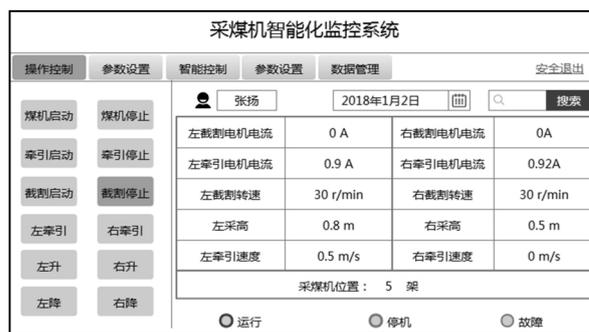
图 6 采煤机操作控制界面
