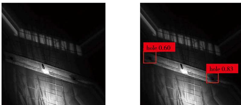
图10 图片中有多个锚孔时检测的效果
