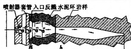
图 9 喷射起裂孔的孔形特征
