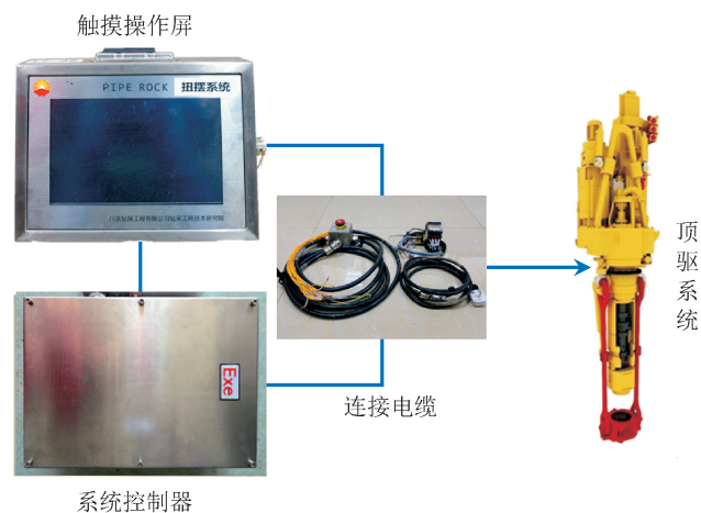
图 1 PIPE ROCK 系统硬件示意图
