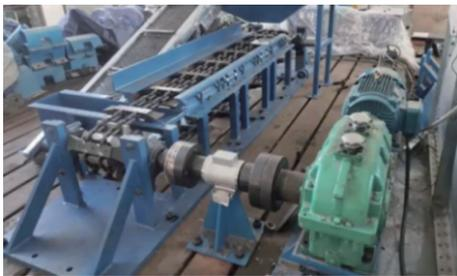
图 2 刮板输送机试验台
