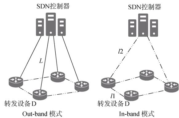
图 9 Out-of-band 和 In-band 部署模式
