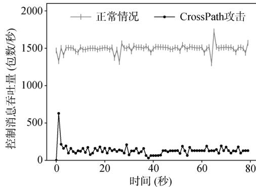
图 10 CrossPath 攻击对控制通道的影响
