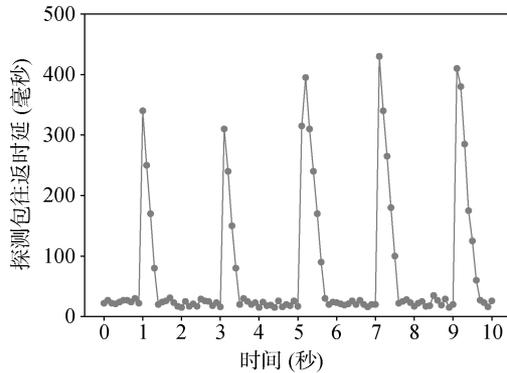
图 14 CrossPath 攻击窃取统计信息查询周期的过程
