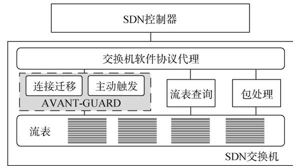
图 19 Avant-Guard 系统架构
