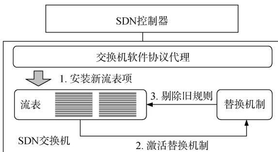
图 24 SDN 交换机中的替换机制
