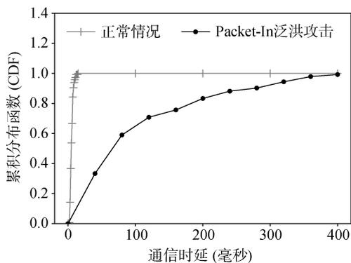
图5 Packet-In 泛洪攻击对主机通信时延的影响
