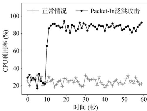
图4 Packet-In 泛洪攻击对控制器 CPU 的影响
