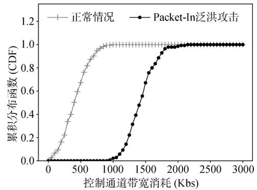
图 11 Packet-In 泛洪攻击对控制通道带宽的影响
