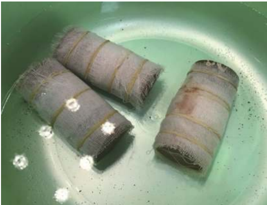
图 2 试样饱水处理
