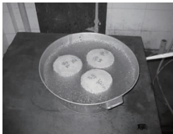
(b) 振动冲刷试验
