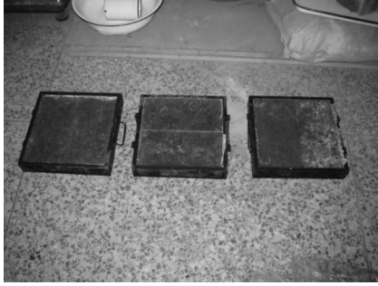
图4 轮碾冲刷试件(原状试件)
