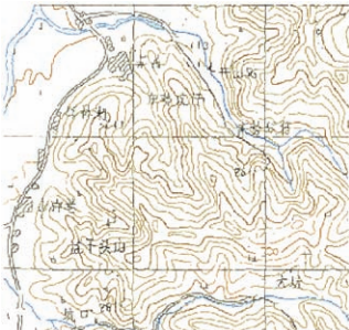
图 4 线化要素细化结果 Fig. 4 Result of thinning procedure
