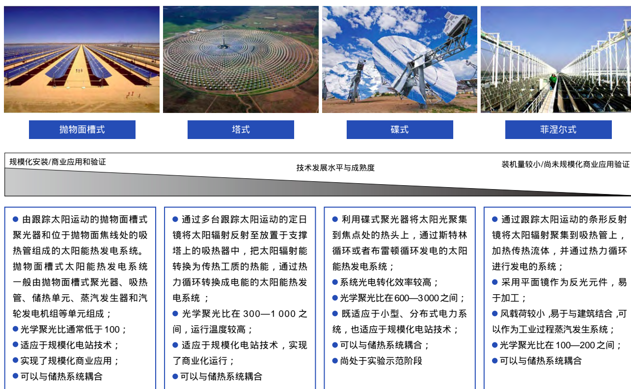
图1 4种主要太阳能热发电技术形式与特点
