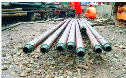
图3 全通径射孔枪图
