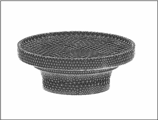
图 2 立式磨磨盘的有限元模型
