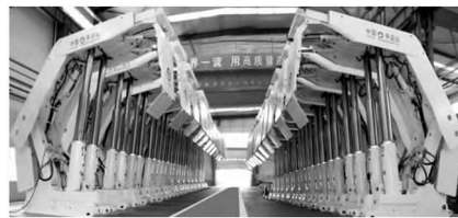
图 4 ZY18800/32.5/7.2 型超大采高综采液压支架
