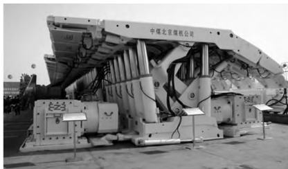
图 3 ZF15000/28/52 四柱大采高放顶煤工作面液压支架
