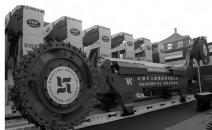
图 2 MG1000/2500 - WD 电牵引采煤机
