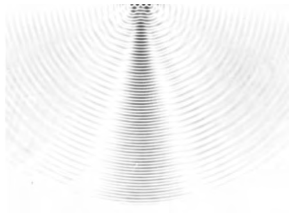
图 6 横波换能器稳态声场
