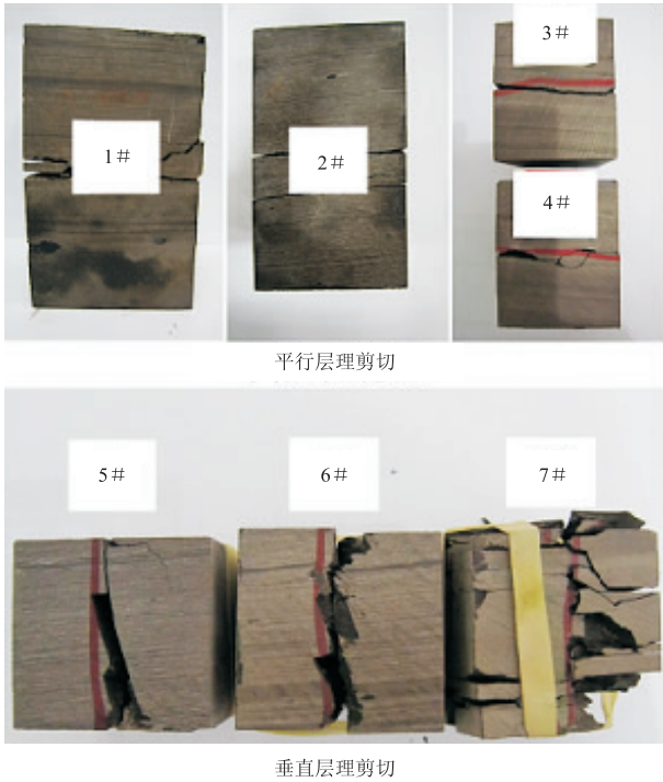
图5 胜利油田罗家地区页岩剪切实验
