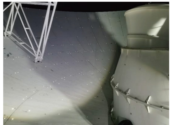
图 7 天线主面摄影测量靶标粘贴实物图
