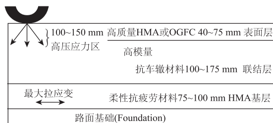
图 1 国际长寿命沥青路面设计模式
