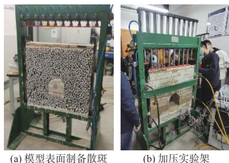
图4 巷道开挖的物理相似模拟
