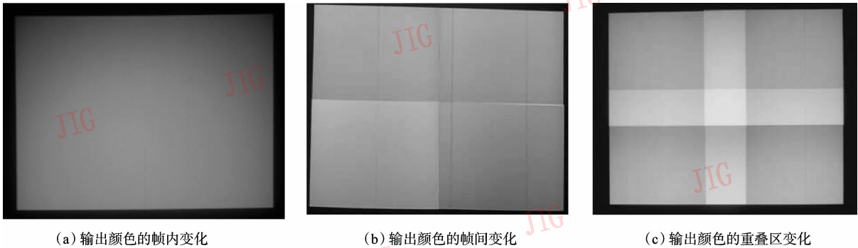
图 1 投影仪输出颜色的空间变化特性 Fig. 1 Spatial color variation of projector
