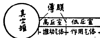
图20 化学激波管简图
