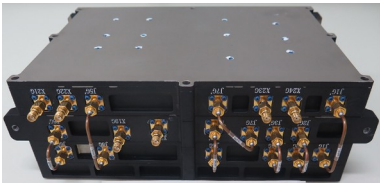
图 5 (网络版彩图)火星车次表层探测雷达电子学单元机箱实物图
