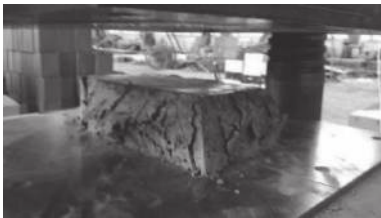
图 3 NSFCB 的大面抗压破坏形态
