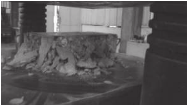
图 2 GCB 的大面抗压破坏形态
