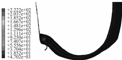
图3 充气完成时轮胎 Mises 应力分布云图 (单位: MPa)
