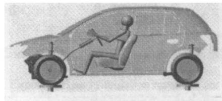
图 12 轿车随机路面激励输入虚拟试验
