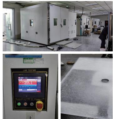
图 10 甲板覆冰破除试验照片
