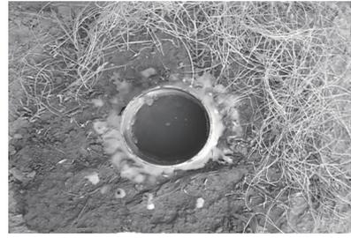
图2 稻秸秆泥皮植被抗渗试验照片
