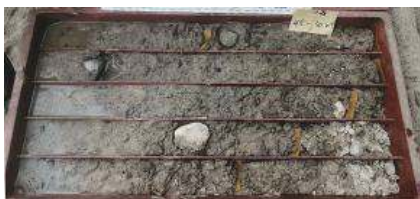
图 6 ZK2 钻孔 45~50 m 砂土岩芯照片
