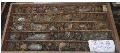
图 7 ZK3 钻孔 52~57 m 的岩芯照片
