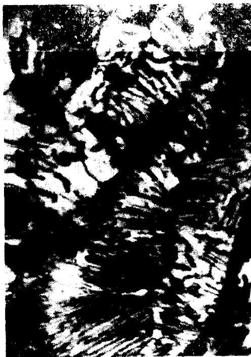
圖4 料鐵不含渣部分的組織——珠光體 4%硝酸液浸蝕
