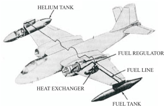
图 3 B-57 飞机液氢燃料系统布置图<sup>[24]</sup>
