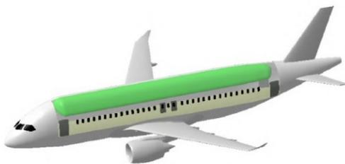
图 2 储氢装置机上布置示意图<sup>[21]</sup>
