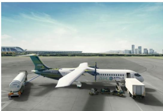
图 4 液氢飞机地面配套设施<sup>[43]</sup>
