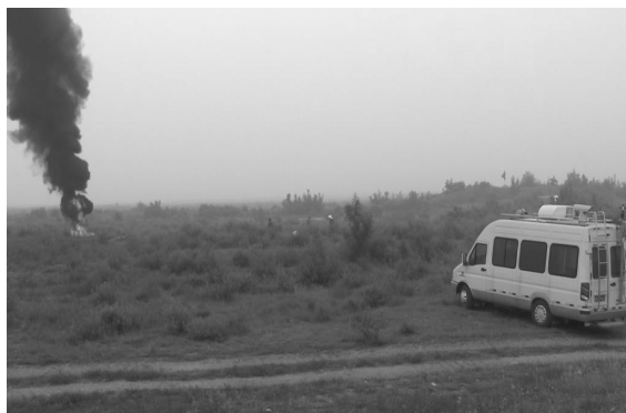
图 3 突发性大气污染监测与预报技术集成移动平台实时监测燃油燃烧实验
